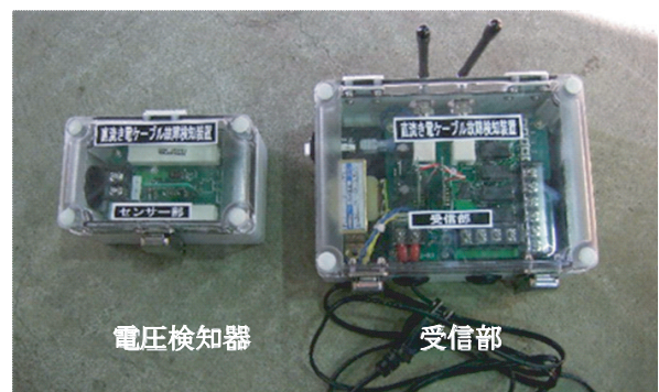
図6 地絡検出装置の外観
