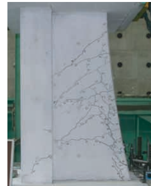
図10 破壊状況 (No.7)
