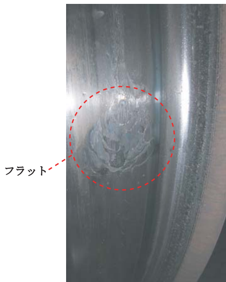
図10 試験後に発見された車輪踏面フラットの例
