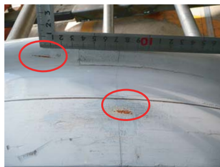
図7 模型輪軸における光明丹の痕跡（アタック角4deg）
