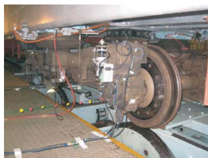
(b) 試験車両の台車に設置した可変減衰軸ダンパ
