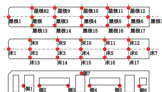
図8 定置加振試験時の車体の加速度測定点 （屋根，床：上下方向，側：左右方向）
