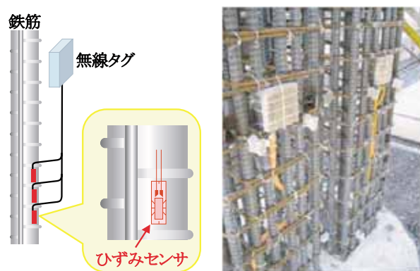
図7 損傷検知センサとその設置状況
