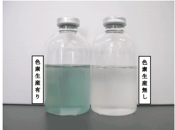
図5 ガラクトース加水分解酵素を利用したトルエンセンサ
