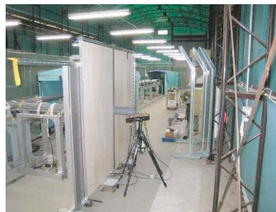
図6 バッフル板がある場合の実験状況 ( L = 315 \text{ mm} )
