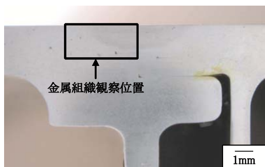
図13 難燃性マグネシウム合金モデル継手のFSW接合部断面の外観
