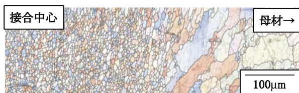
図5 接合部のEBSD解析による方位解析結果
