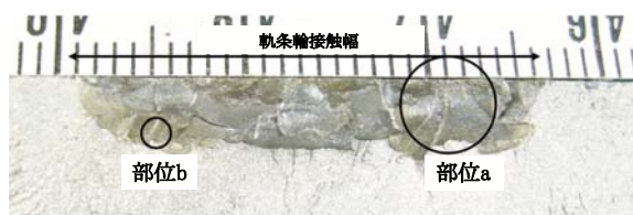
図10 き裂の開口破面 (主き裂)
