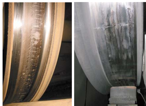
(a) 実車の熱き裂 (b) 定置ブレーキ試験後
