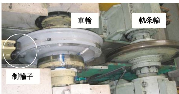
図2 試験に使用した粘着測定ユニットの構成
