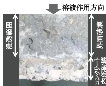
図9 溶液の浸透と破壊位置との関係
