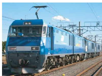
図11 試験車両 EH200形式直流電気機関車
