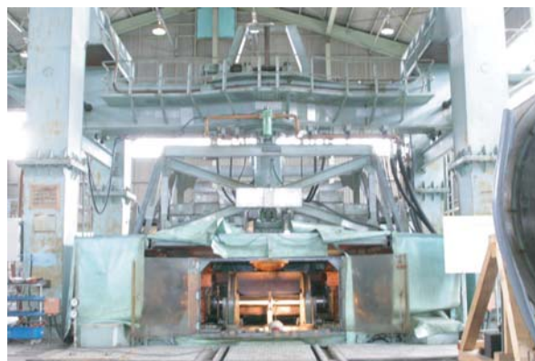
図10 輪軸疲労試験装置の外観
