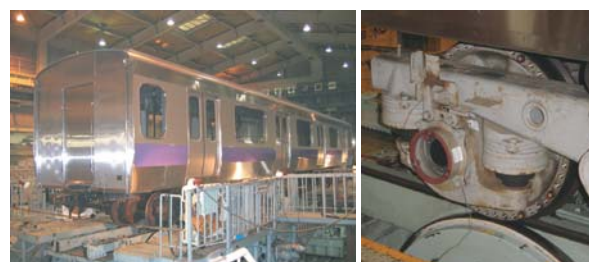
(a) 全景 (b) 車輪と軌条輪 図3 車両試験台加振試験の状況
