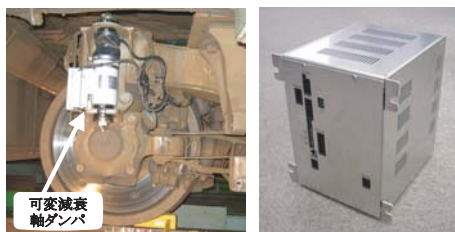
図2 可変減衰軸ダンパと試作制御装置(営業車搭載用)
