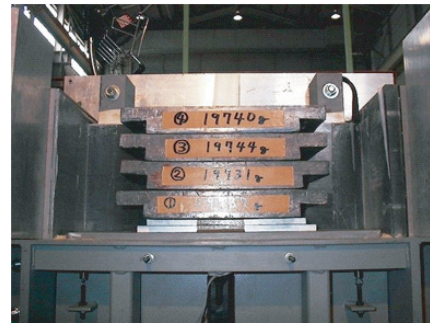
図9 上載荷重の載荷状況
