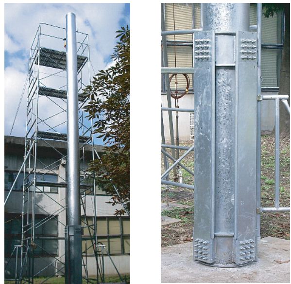
(a) 試験用電柱(鋼管柱) (b) 制振器 図7 実スケールモデルにおける加振試験
