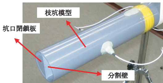
図5 分割壁付き枝坑模型 ( \sigma=0.5 , l=0.3m )
