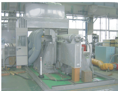
図5 ICタグ埋込コイル耐久性試験状況
