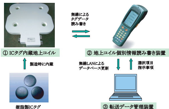
図6 地上コイル個別情報管理手法の構成
