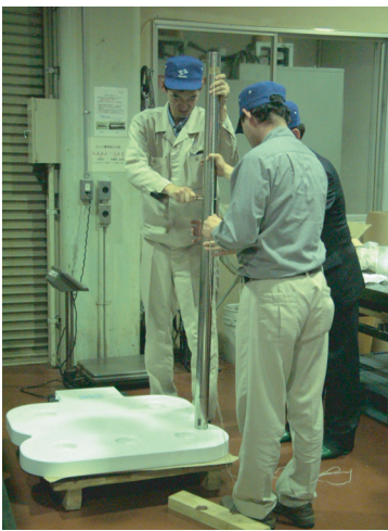
図5 落錘試験の様子
