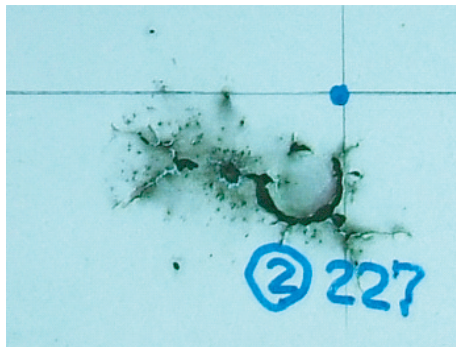
(b) 地絡発生後(試験後)
