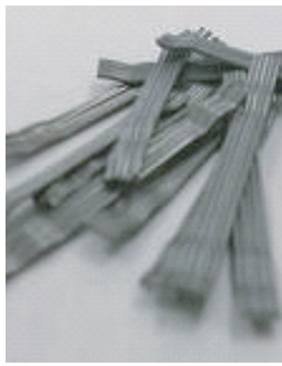
繊維径：0.6mm 繊維長：30mm 引張強度の規格値： 1000N/mm 2
