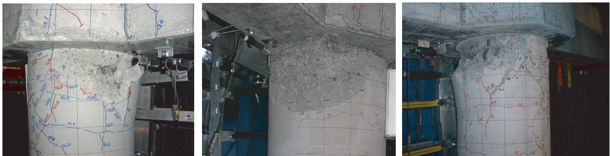
(a) 基準(定着良好) (b) S3(定着不良) (c) S5(定着良好)
