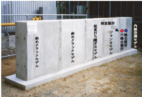
図3 欠陥を模擬した大型コンクリート供試体
