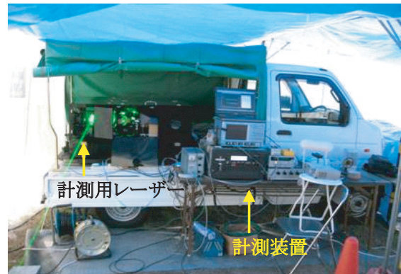
図2 レーザーリモートセンシングシステムの試作機
