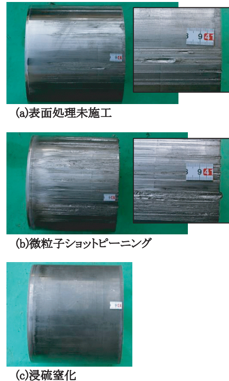
図8 圧抜き後の車軸試験片の外観
