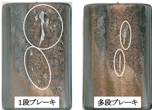
図4 発生したかじり鉄片 (湿潤下に8号珪砂散布条件)
