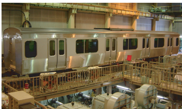
図3 車両試験台における加振試験
