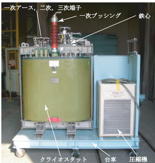
図7 超電導主変圧器
