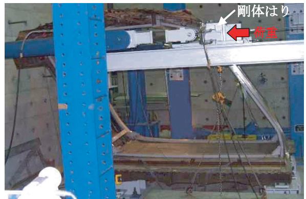
図8 最大押込み時の変形状 (インナーリング試験体)
