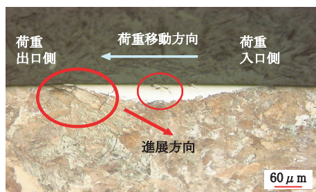
図11 微小き裂再現例
