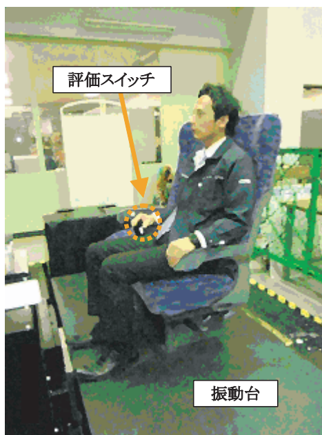
図1 振動台上の座席に着座した被験者
