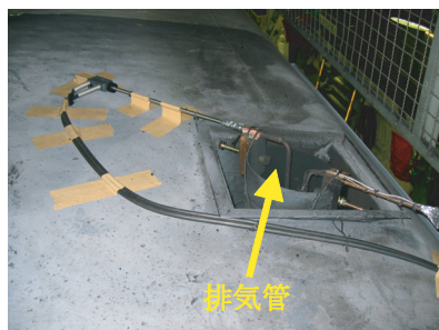
図4 車両屋根上のプローブ取付方法
