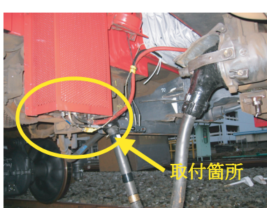
図5 排気管下部のプローブ取付方法
