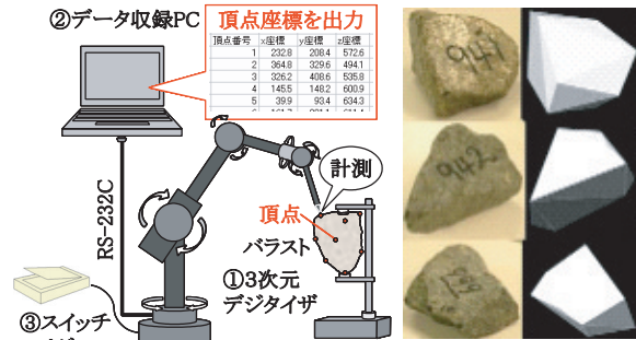
図1 砕石形状測定装置と測定結果の例
