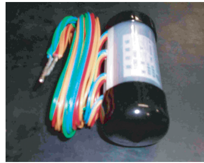
図2 装荷線輪の外形例(130mH, 4回線用)
