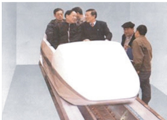
図4 中国西南交通大学の高温超電導磁気浮上車両 2)
