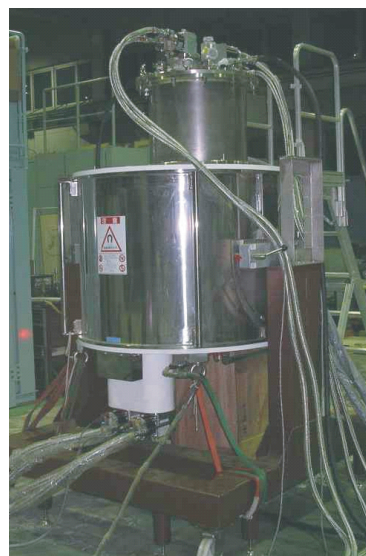
図6 I-B-θ-T 試験装置
