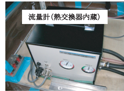
図8 DMV 車両概観と燃費測定の様子
