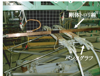
図2 剛体トロリとパンタグラフすり板の連続通電による温度上昇試験（最大電流1000A）
