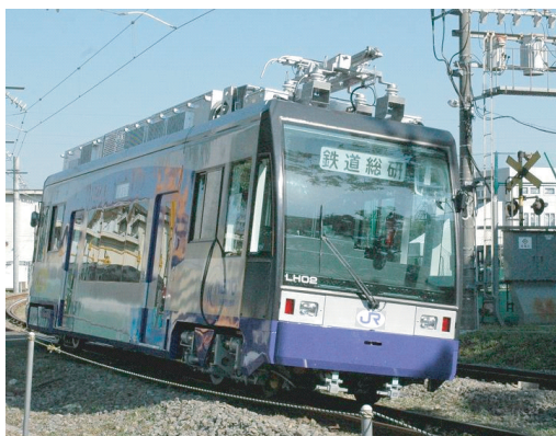
図1 架線・バッテリーハイブリッド LRV
