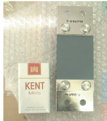
図13 SiC接地抵抗器（200A）の抵抗体
