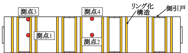
図5 リング化構造の配置と振動測定点
