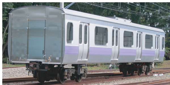
図1 剛性試験車体の外観
