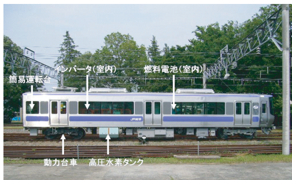
図9 燃料電池試験電車の構成
