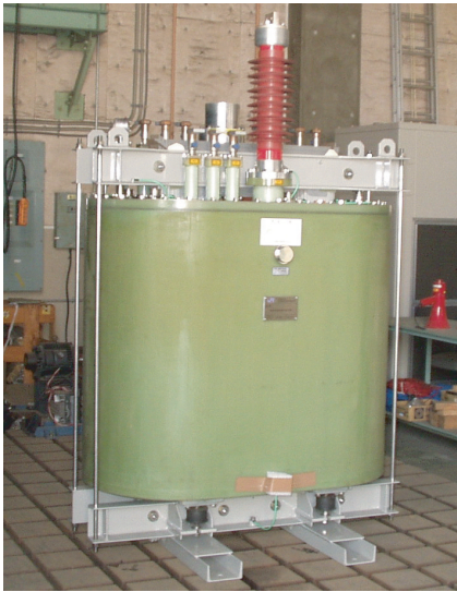
図2 試作した超電導主変圧器
