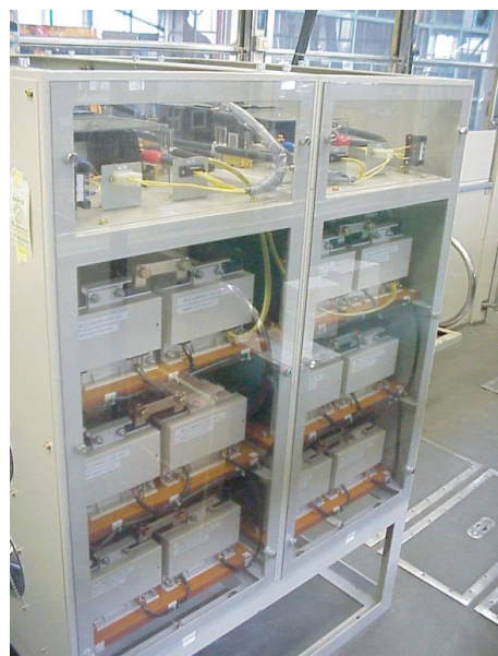
図5 開発したリチウムイオン二次電池
