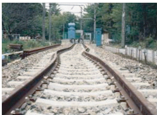
図6 軌道座屈（実物大試験）
