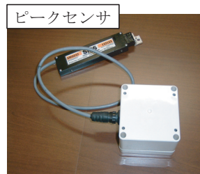
図5 損傷レベル検知用ノード無線機
