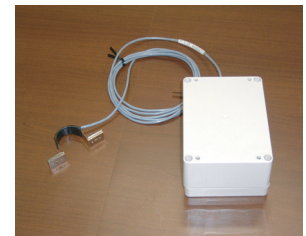
図6 π型変位計用ノード無線機
