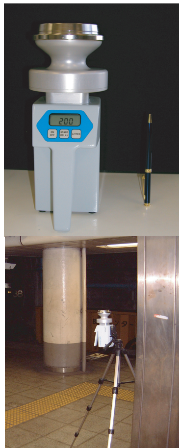
図3 吸込み型捕獲装置(上)と設置風景(下)
