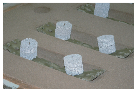
図16 設置されたフィルタ
