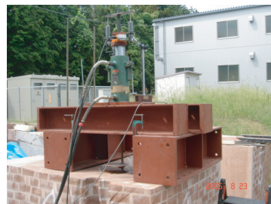
図14 引抜き試験状況
