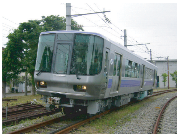
図1 燃料電池試験電車の構内走行試験状況
