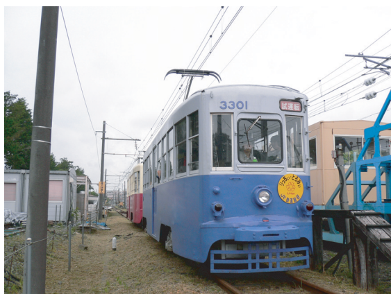
図13 1500V架線ハイブリッド供試車両（2両連結：空車質量39.4トン）
