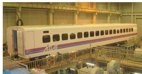
図7 車両試験台における加振試験風景
