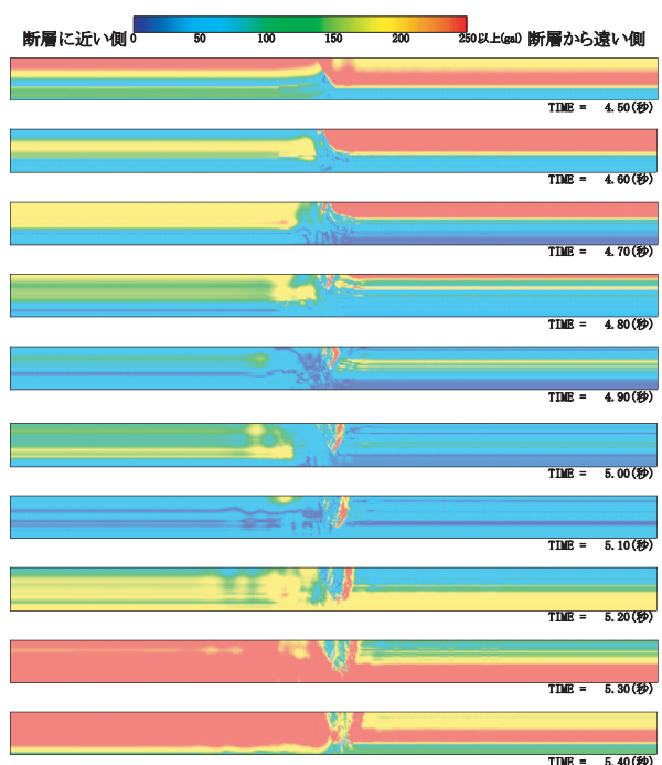
図 12 Case2 (一様入力) の加速度コンター図 (縦方向の縮尺 3 倍)
